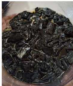
Gambar 4. Proses Perendaman Minyak dengan Arang
